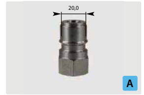
Stecknippel : IG. Edelstahl gehärtet. Max. 250 bar / 150 °C
