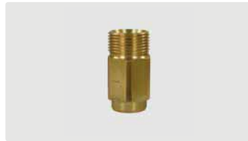
M22 AG : IG. Langbohrung. Max. 400 bar / 150 °C
