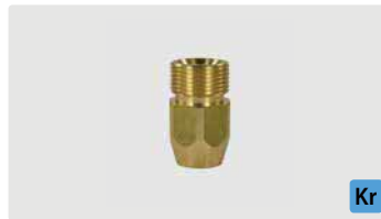
M22 : IG. Innensechskant. Max. 400 bar / 150 °C
