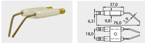
Doppelzündelektrode "K"
