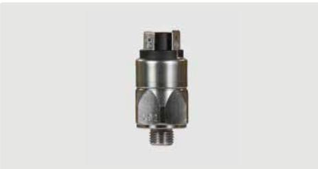
Edelstahl. Kontakt 4 A - 24 V-250 V. Dichtungen EPDM. Verwendbar als Wassermangelsicherung. Max. 300 bar / 90 °C
