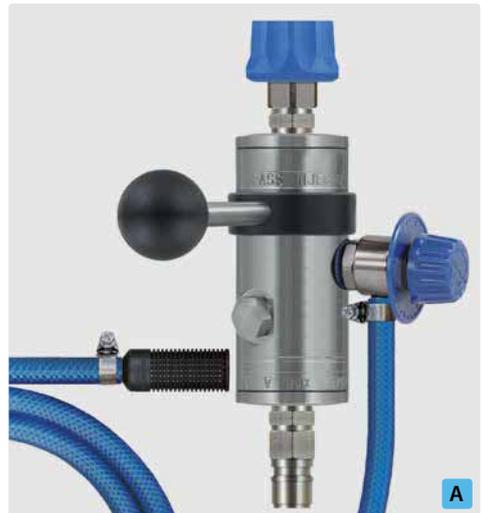
Kupplung ST-45-250 Messing vernickelt : Stecknippel ST-45-250 Edelstahl. Injektor ST-167 mit Dosierventil ST-161, Saugschlauch 2.000 mm und Saugfilter ST-31. Max. 250 bar / 100 °C
