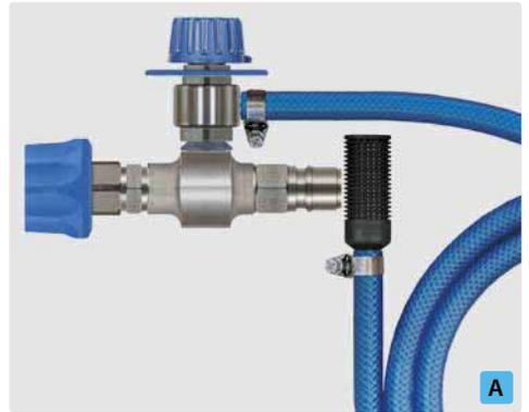
Kupplung ST-45-250 Messing vernickelt : Stecknippel ST-45-250 Edelstahl. Injektor ST-160 mit Dosierventil ST-161, Saugschlauch 2.000 mm und Saugfilter ST-31. Max. 250 bar / 90 °C
