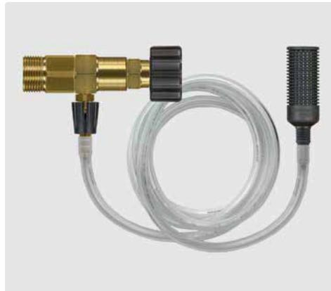
Injektor mit Dosierung, Saugschlauch 1.000 mm und Ansaugfilter ST-31. Max. 220 bar / 90 °C
