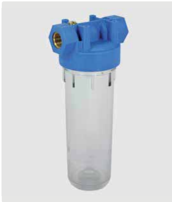
2-teilig. Entlüftungsstopfen. Innengewinde Messing. Max. 10 bar / 50 °C
