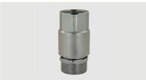
Messing verchromt. Rückflussverhinderer nach DIN 19884 und DIN EN 1717. Damit bei Überdruck in der Wasserleitung kein Reinigungsmittel in den Trinkwasserkreislauf gerät. Vorgeschrieben bei direkter Leitungsverbindung zur Pumpe
