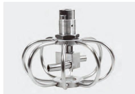
TYR-2f fest. Rohrreiniger mit geraden Rotorarmen für radial wirkenden Sprühwinkel. Ideal für die vertikale Schachtreinigung. Komplett rostfrei. Eingang 3/8" IG. Lieferung erfolgt ohne Düsen. Es werden 2 Düsen mit 1/8" AG benötigt. Max. 275 bar / 120 °C
