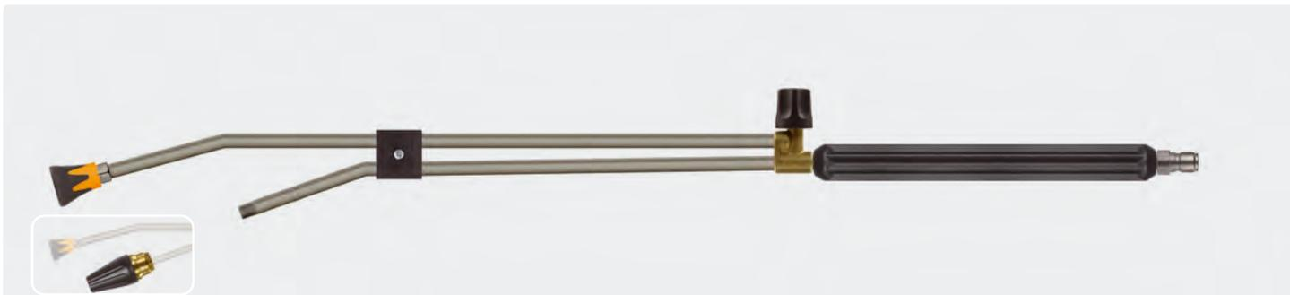
Stecknippel ST-3100. Strahlrohr aus Edelstahl, umspritzte Isolierung 300 mm, Ventil ST-53 oben, Düsenschutz ST-10 mit Niederdruckdüse und 1/4" AG Anschluss für Rotordüsen. Strahlrohre werden ohne Rotordüsen geliefert. Max. 250 bar / 150 °C
