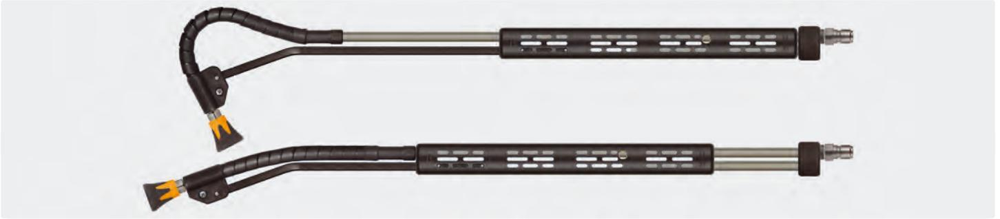
Stecknippel ST-3100. Strahlrohr aus Edelstahl, Isolierung ST-9 380 mm und Düsenschutz ST-10 ohne Düse. Stufenlose Verstellung des Biegewinkels der Lanze von 20 - 140°. Sie erreichen jeden Winkel ohne Verrenkungen und mühelos. Max. 210 bar / 150 °C
