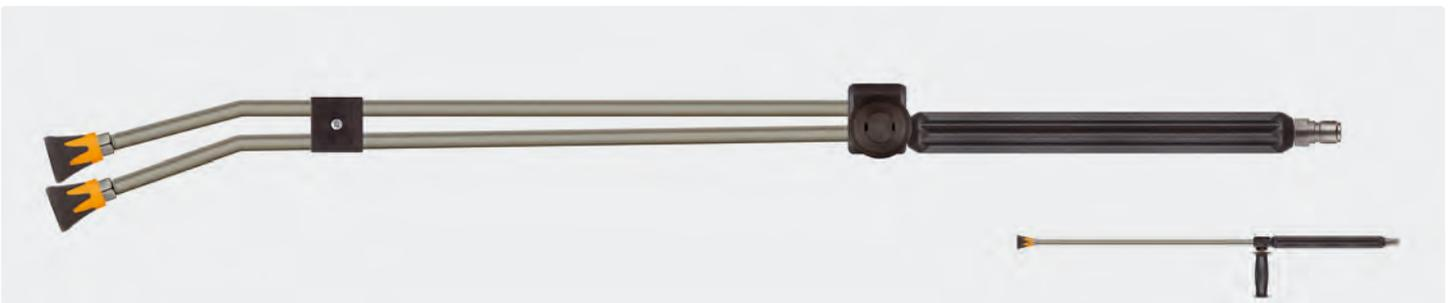
Stecknippel ST-3100. Strahlrohr aus Edelstahl, umspritzte Isolierung 300 mm, Ventil ST-54 seitlich und Düsenschutz ST-10 mit Niederdruckdüse & Muffe 1/4" IG. Max. 310 bar / 150 °C
