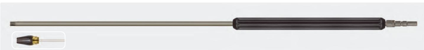
Stecknippel KW. Strahlrohr aus Edelstahl, umspritzte Isolierung 400 mm und 1/4" AG Anschluss für Rotordüsen. Strahlrohre werden ohne Rotordüsen geliefert. Max. 400 bar / 150 °C
