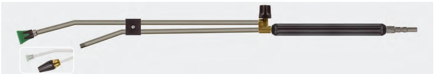
Stecknippel KW. Strahlrohr aus Edelstahl, umspritze Isolierung 300 mm, Ventil ST-53 oben, Düsenschutz ST-10 mit Niederdruckdüse und 1/4" AG Anschluss für Rotordüsen. Strahlrohre werden ohne Rotordüsen geliefert. Max. 250 bar / 150 °C
