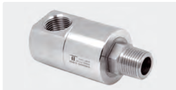
DGEI 90°. Gehäuse Edelstahl. 3-fach gelagert. Max. 350 bar
