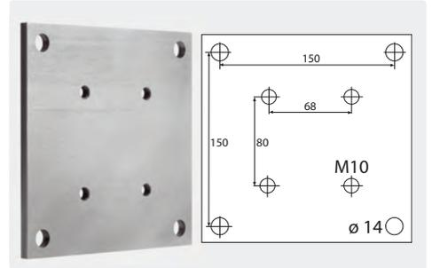
Für Decken- oder Wandmontage. Edelstahl. 180 x 180 mm. Stärke 8 mm. 4 x M10 zur Aufnahme des Wand- und Deckenkreisels
