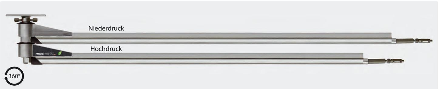
Edelstahl. Montagefertig für die Installation mit 3 integrierten Qualitätsdrehgelenken, professionellem Hochdruckschlauch mit Zugentlastungsfeder sowie integriertem Knickschutz. Achse 2-fach gelagert sowie permanent geschmiert. Speziell für 2 unterschiedliche Medien und Anwendungen entwickelt. Max. 275 bar / 90 °C. **Achtung: Lieferzeit ca. 2 Wochen!**
