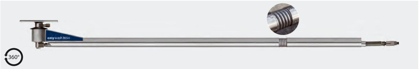
Edelstahl. Montagefertig für die Installation mit 2 integrierten Qualitätsdrehgelenken, professionellem Hochdruckschlauch mit Zugentlastungsfeder sowie integriertem Knickschutz. Achse 2-fach gelagert sowie permanent geschmiert. Max. 275 bar / 90 °C.
