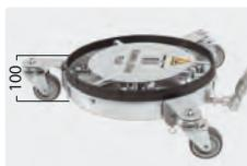
Dank der niedrigen Bauweise, muss das zu reinigende Objekt während der Unterbodenwäsche nicht einmal auf eine Hebebühne.
