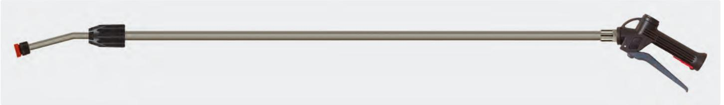
1.000 - 2.000 mm. Chemiepistole mit Teleskoplanze aus Edelstahl und Düsenhalter ohne Düse. Pistole mit chemiebeständiger Edelstahlkugel V4A / AISI 316. Max. 25 bar / 30 l/min / 50 °C
