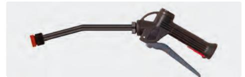
210 mm. Chemiepistole mit Lanze aus Kunststoff und Düsenhalter ohne Düse. Pistole mit chemiebeständiger Edelstahlkugel V4A / AISI 316. Vitondichtungen. Max. 25 bar / 30 l/min / 50 °C
