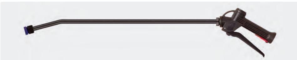
600 mm. Chemiepistole mit Lanze aus Kunststoff und Düsenhalter ohne Düse. Pistole mit säurebeständiger Kugel. Max. 25 bar / 30 l/min / 50 °C
