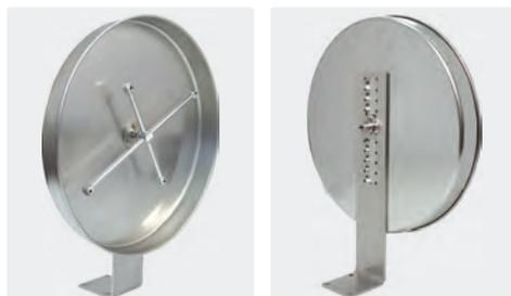
Poliertes Edelstahl. Zubehör für automatische Waschanlagen. Schnellläufer Drehgelenk. Rotorarm wird durch Wasser angetrieben. Höhenverstellbar. Anschluss über einen Schlauch des Pumpensystems. Es werden 4 Düsen mit 1/8" AG NPT benötigt. Rotor 470 / 350 mm. Max. 250 bar / 2.000 U/min / 120 °C
