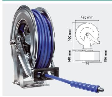
Schlauchaufroller: Edelstahl V2A / AISI 304. Mit automatischem Federrückzug und Zugentlastung. Suttner Drehgelenk ST-322 aus Edelstahl. Max. 90 °C
