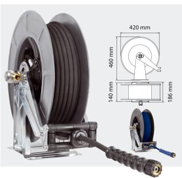
Schlauchaufroller: Gestell aus Edelstahl V2A / AISI 304. Trommel aus besonders schlagfestem ABS Kunststoff, mit automatischem Federrückzug und Zugentlastung. Suttner Drehgelenk ST-322 aus Edelstahl. Max. 90 °C
