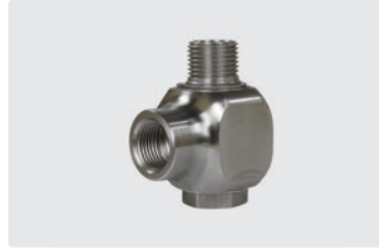
1/2" IG : 1/2" AG. DN 12. Max. 30 U/min / 90 °C
