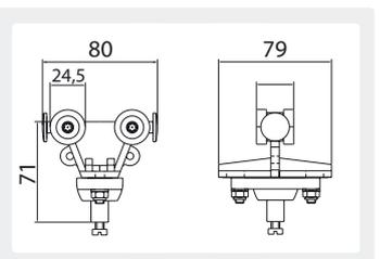
Für Profil 32 x 30 mm. Tragfähigkeit 5 kg. Laufrollen mit Stahlachse. - 30 °C - + 60 °C
