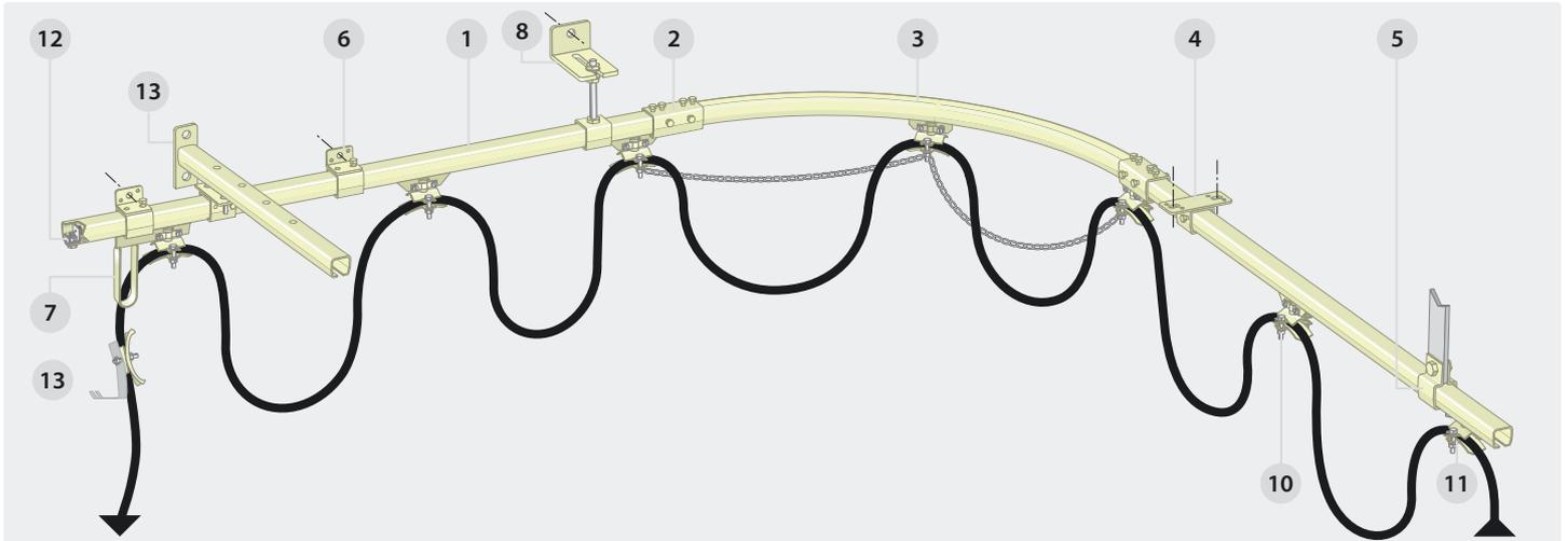
Bei einer Bogenanlage ist es ratsam, die Fahrwagen mit einer Kette zu verbinden.
