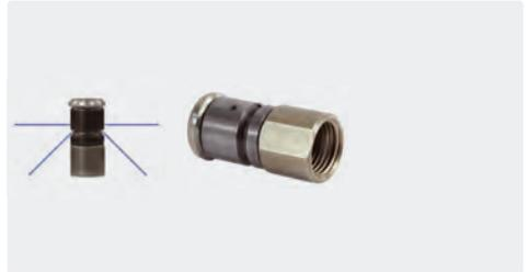
1/8" IG. Düse mit Zugwirkung. Rostfreier Edelstahl. Gehärteter Edelstahlrotationskörper. Kompakte Bauform, für universellen Einsatz. Extrem hohe Reinigungsleistung.  $\varnothing$  12 mm. Max. 500 bar
