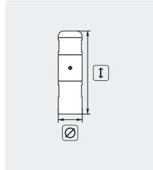
1/8" IG. Seitenstrahl 2. Rostfreier Edelstahl. Rotationskörper Hochdruckbronze. Kompakte Bauform, universell einsetzbar. Extrem hohe Reinigungsleistung, entfernt härteste Ablagerungen.  $\updownarrow$  63 mm.  $\varnothing$  12 mm. Gewicht 0,18 kg. Max. 1.000 bar
