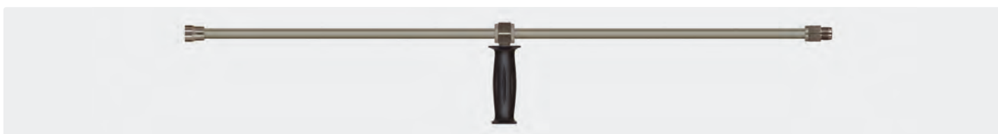
1/2" AG. Strahlrohr mit Handgriff und Muffe 1/4" IG aus Edelstahl ohne Hochdruckdüse. Max. 600 bar / 150 °C
