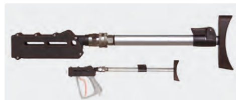
ST-3900 Schulterstützen. Neue EU-Richtlinien schreiben den Gebrauch von Schulterstützen bei Arbeiten mit einer Rückstoßkraft von mehr als 150 N zwingend vor. Stufenlos verstellbare Schulterstütze. Drehbare Kupplung. Geeignet für alle Pistolen ST-3600 / ST-3500.
