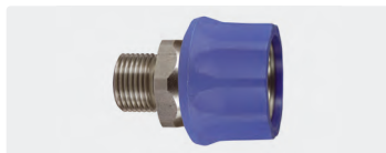
Kupplung : AG. Edelstahl. 60° Dichtkonus. Max. 250 bar / 150 °C
