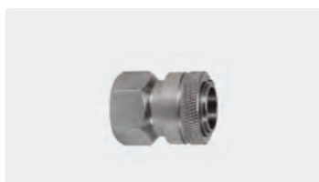
Kupplung : IG. Edelstahl. Max. 150 bar / 90 °C
