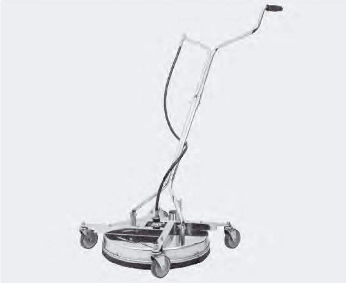
Komplett Edelstahl. Mit zusätzlichem Rahmen für höchste Stabilität und einem höhenverstellbaren Gehäuse inklusive einer Absaugungsvorrichtung. Teilbarer Fahrbügel für platzsparenden und preisgünstigen Transport. Es werden 2 Düsen benötigt. Absaugungssystem passend für 50 mm Saugschlauch. 4 Lenkrollen (100 mm).
