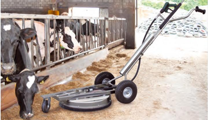
Flächenreiniger mit teilbarem Fahrbügel. Drehgelenk mit Hartmetalldichtung. Lenkrolle in (30 mm) zum Fahren auf Spaltenböden. 2 sehr große Hinterreifen. Es werden 2 Düsen 1/4" AG benötigt.
