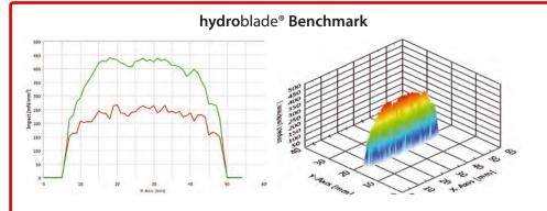
hydroblade® Flachstrahldüsen zeichnen sich durch gleichmäßige Flüssigkeits- und Druckverteilung aus. Besonders energiereiche Strahlen werden bei Strahlwinkeln bis 40° erzielt.
