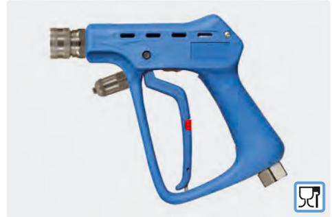
Professionelle Pistole mit Abschaltverzögerung und Kupplung ST-3100. Edelstahl. Anwendung z. B. Schaum- und Spülanwendungen in der Lebensmittelindustrie. Industriestandard. Max. 60 bar / 100 l/min / 150 °C
