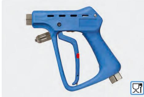
Professionelle Pistole mit Abschaltverzögerung. Edelstahl. Anwendung z. B. Schaum- und Spülanwendungen in der Lebensmittelindustrie. Industriestandard. Max. 60 bar / 100 l/min / 150 °C
