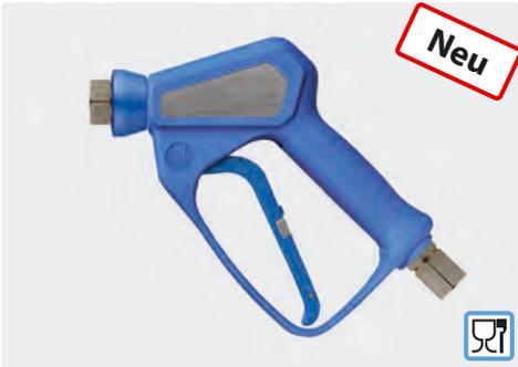
Professionelle Pistole. Anwendung z. B. Schaum- und Spülanwendungen in der Lebensmittelindustrie. Edelstahl/Messing. Ventilkolben aus Edelstahl. PEEK Sitz. EPDM Dichtung.
