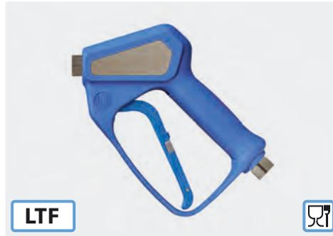
Professionelle Pistole mit patentierter LTF Technik. Edelstahl. Keramik-Kugel, chemiebeständiges Ventil und säurebeständiger Dichtsatz aus Edelstahl. Pistole für industrielle Anwendungen mit aggressiven Medien.
