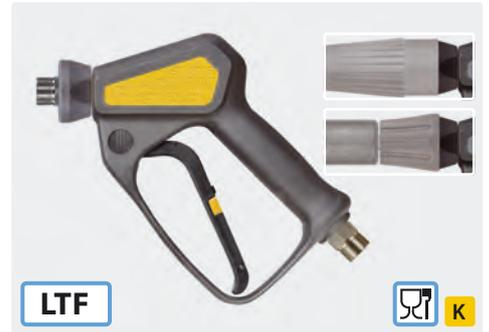
Professionelle Pistole mit patentierter LTF Technik. Edelstahl. Keramik-Kugel, chemiebeständiges Ventil und säurebeständiger Dichtsatz aus Edelstahl. Pistole für industrielle Anwendungen mit aggressiven Medien.
