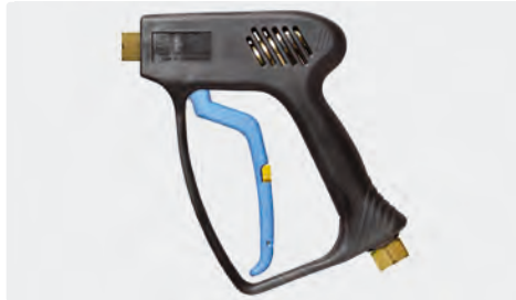
Professionelle Pistole. Weepausführung. Max. 275 bar / 45 l/min / 150 °C
