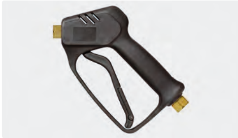
Professionelle Pistole. Max. 210 bar / 25 l/min / 150 °C
