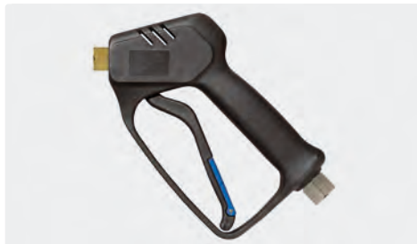
Professionelle Pistole. Weepausführung. Max. 210 bar / 25 l/min / 150 °C
