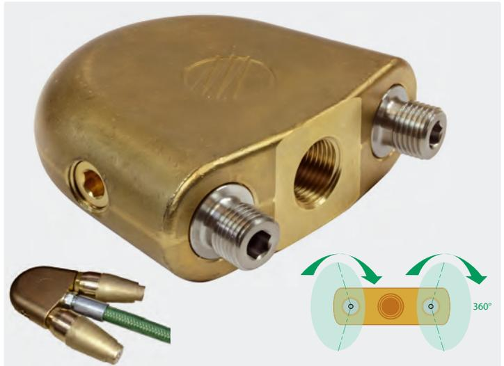
Als Träger für 2 Rotordüsen ST-357. Die Flunderdüse ist die ideale Lösung für das Freispülen von festsitzenden Ablagerungen. Durch die rotierenden Strahlen wird die Spülwirkung bei unter Wasser stehenden Rohrleitungen vervielfacht. Die schwere, geschmiedete Messingausführung hält den Strahl in der Nähe der Schmutzansammlungen am Boden und befördert diese zur Einstiegsöffnung.
