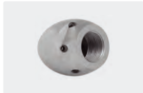
1/2" IG. 6x 75° +1x 0°. 30-100 l/min. Für R Ø 100-200 mm. Außen Ø 40 mm. 281 g.
