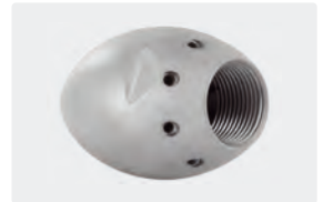
1" IG. 8x 75° +1x 0°. 100-250 l/min. Für R Ø 150-300 mm. Außen Ø 62 mm. 1.265 g.
