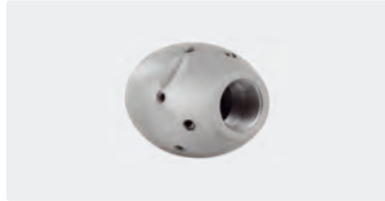
3/8" IG. 6x 75° 3x 30° +1x 0°. 30-100 l/min. Für R Ø 100-200 mm. Außen Ø 35 mm. 314 g.
