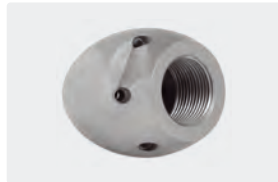
3/4" IG. 6x 75° +1x 0°. 30-100 l/min. Für R Ø 120-250 mm. Außen Ø 50 mm. 567 g.
