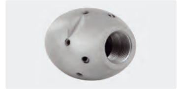
3/4" IG. 6x 75° 3x 30° +1x 0°. 100-250 l/min. Für R Ø 150-300 mm. Außen Ø 50 mm. 1.367 g.
