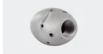
1/2" IG. 6x 75° 3x 30° +1x 0°. 80-140 l/min. Für R Ø 120-250 mm. Außen Ø 40 mm. 630 g.
