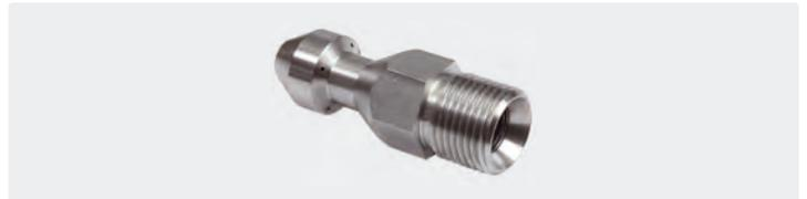
Rohrreinigungsdüse für Standard-Anwendungen. ☞ Bohrungen hinten für gute Zugwirkung. Frontbohrung zum Durchbrechen von Verstopfungen oder Enteisen. Konische Spitze für enge Rohrbögen und Vorsprünge.
