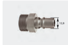
Stecknippel : AG. Edelstahl. Max. 350 bar / 100 °C
