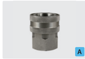
Kupplung : IG. Edelstahl. Max. 250 bar / 150 °C
