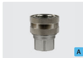
Kupplung : IG. Messing vernickelt. Max. 250 bar / 150 °C
