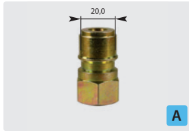
Stecknippel : IG. Stahl verzinkt. Max. 250 bar / 150 °C
