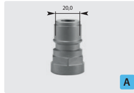
Stecknippel : IG. Edelstahl gehärtet. Max. 250 bar / 150 °C
