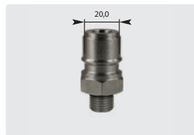
Stecknippel : AG. Edelstahl gehärtet. Max. 250 bar / 150 °C
