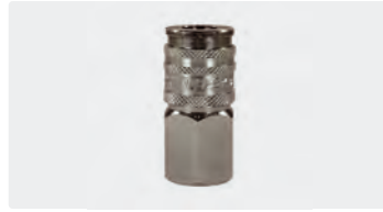
Kupplung : IG. Messing/Stahl, vernickelt. Max. 200 bar / 100 °C
