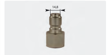
Stecknippel : IG. \varnothing 14,8 mm. Stahl verzinkt. Max. 250 bar / 100 °C
