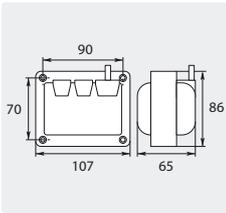
Anschluss Zündkabel mit selbstschneidender Schraube. Leistung 2 x 4.000 V / 12 mA / 100 % ED
