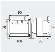
Anschluss Zündkabel mit Zündstecker  $\varnothing$  4 mm. Leistung 2 x 5.000 V / 20 mA / 100 % ED
