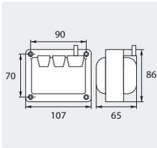
Anschluss Zündkabel mit Zündstecker  $\varnothing$  4 mm. Leistung 2 x 4.000 V / 12 mA / 100 % ED
