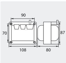
Anschluss Zündkabel mit selbstschneidender Schraube. Leistung 2 x 5.000 V / 20 mA / 100 % ED
