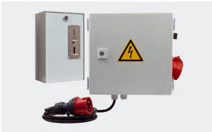
R+M Münzautomat, mechanisch mit Geldrückgabe inkl. Steuerkasten, IP 66, RAL 7035 mit Einspeisung 2 Meter Leitung mit CEE-Stecker, 16 A, 400 V AC, 50 HZ, 3 Ph/N/PE. Steuerspannungsaufbereitung 24 V AC, 20 VA mit 2 Sicherungsautomaten.
