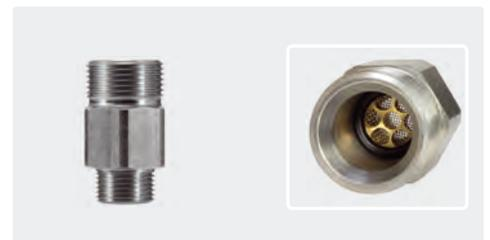
Edelstahl mit Siebhalter aus Messing. Geeignet als Vorfilter für Injektor ST-164. Max. 400 bar / 100 °C
