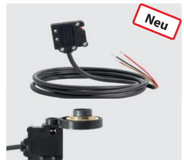
Schalter für Suttner Umlaufventil ST-265. Schutzklasse IP 6K7. Kabel 1.200 mm, 3xAWG20. Max. Einschaltstrom 10mA-5A(2A). Volt: 12-24VDC, 12-250VAC
