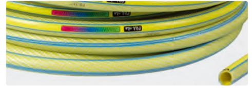
NTS yellow. Weicher und handlicher Gartenschlauch in Gelb. AUFBAU: 6-lagig mit gelber Innenlage, schwarzer Antialgen-Schutzschicht, gelber Zwischenschicht, NTS-Gewebeverstärkung, transparentem Außenmantel und SKY TECH-Beschichtung mit speziellem UV-Schutz gegen Schlauchalterung, die der Schlauchoberfläche ein mattes Finish verleiht. -20°C/+60°C
