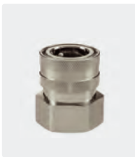
ST-45. Messing vernickelt. Kupplung : 1" IG. 25 bar / 90° C
