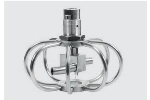
TYR-2f fest. Rohrreiniger mit geraden Rotorarmen für radial wirkenden Sprühwinkel. Ideal für die vertikale Schachtreinigung. Komplett rostfrei. Eingang 3/8" IG. Lieferung erfolgt ohne Düsen. Es werden 2 Düsen mit 1/8" AG benötigt. Max. 275 bar / 120 °C
