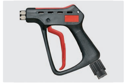
Professionelle Höchstdruckpistole. Max. 600 bar / 80 l/min / 150 °C
